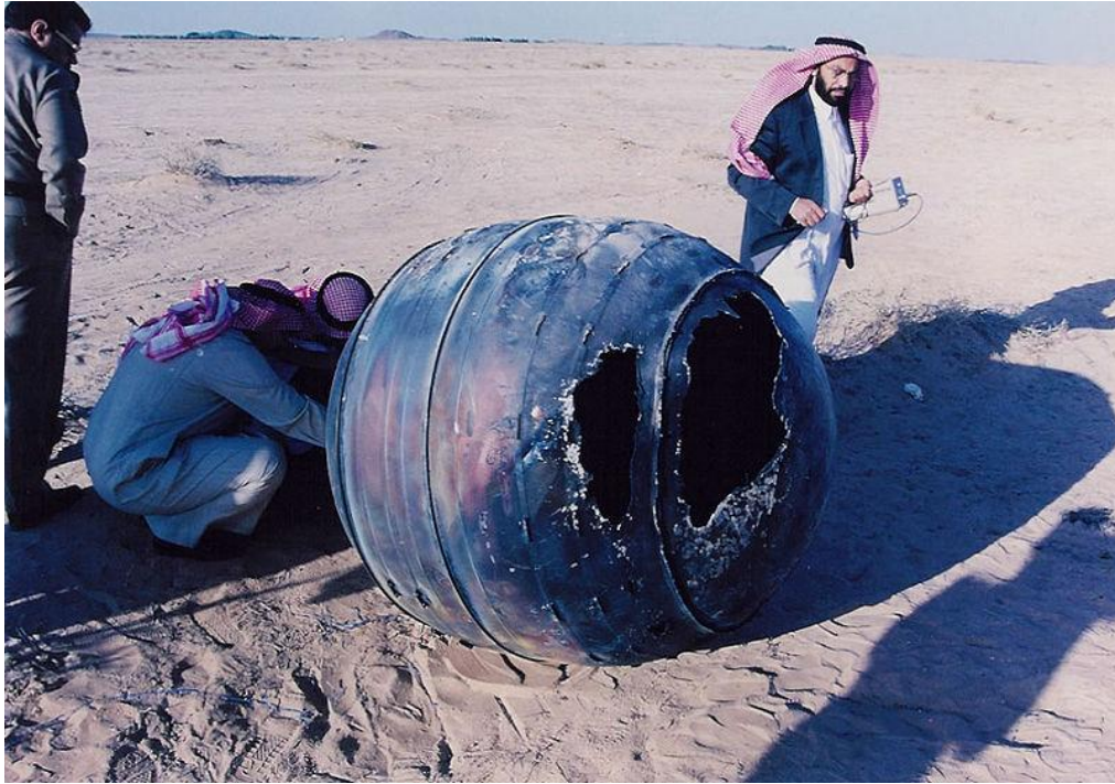
Figura 1.7: Módulo PAM-D de um foguete classe Delta II, encontrado na Arábia Saudita.
